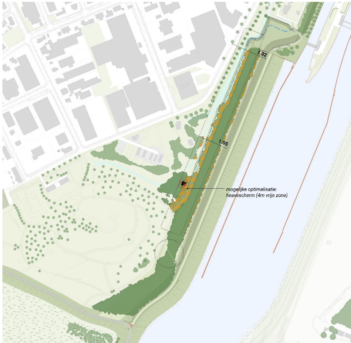
Figuur 4.4 Bovenaanzicht dijkontwerp deeltraject 1: Voorhavendijk
