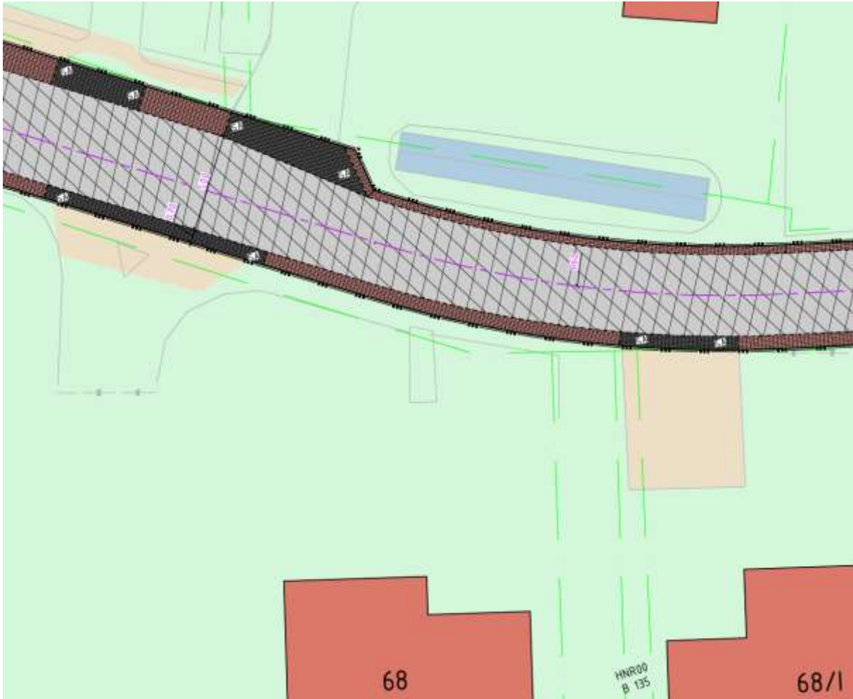
Afbeelding: bredere bermverharding van klinkers bij het brede weggedeelte (linksboven op de afbeelding) om de weg visueel smal te houden.
