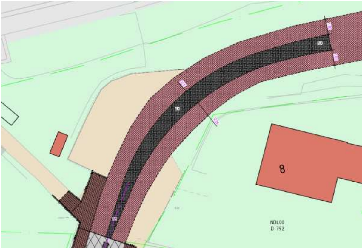
Afbeelding: geleiding van het wegverkeer door een brede middenstrook in de bocht.
