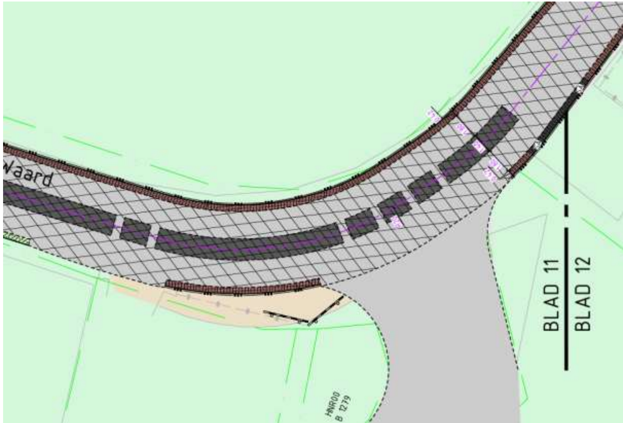
Afbeelding: geleiding van het wegverkeer door een brede middenstrook in de scherpe bocht na de brug.
