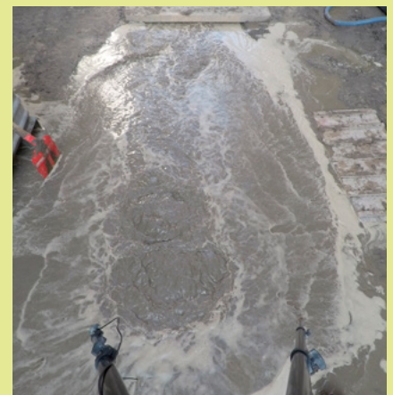
De succesvol opgewekte pipe leidt tot doorbraak van de grofzandbarrière en uiteindelijk tot falen van de dijk.
