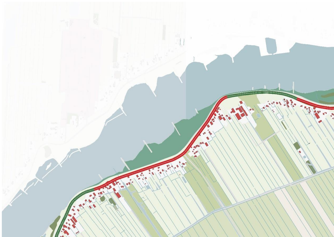
Figuur 14-2: Overzicht Dijkzone 11 Streefkerk (dijkvak 85-86). De groene lijn geeft aan welk gedeelte van de dijk nu niet versterkt hoeft te worden (geen prioritaire opgave). De rode lijn duidt de prioritaire opgave aan.
