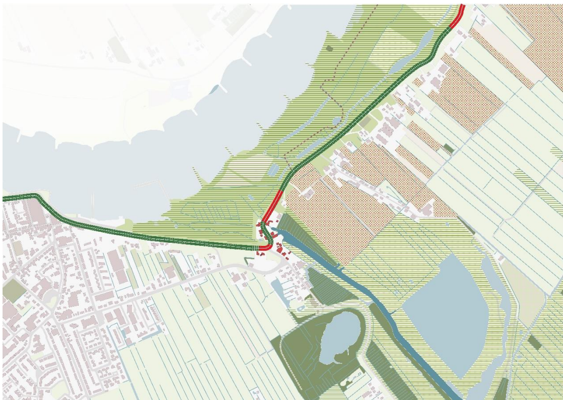
Figuur 11-1: Overzicht van Dijkzone 8 Sluis. De groene lijn geeft aan welk gedeelte van de dijk nu niet versterkt hoeft te worden (geen prioritaire opgave). De rode lijn duidt de prioritaire opgave aan.
