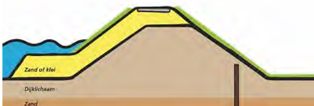
Figuur B3.6 Schematische weergave oplossingsrichting Grond buitenwaarts + constructies binnenzijde
