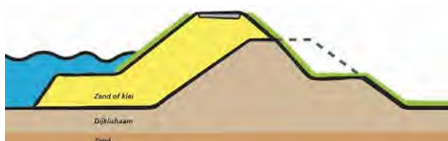
Figuur B3.7 Schematische weergave oplossingsrichting Grond buitenwaarts
