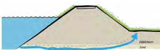
Figuur B3.3 Faalmechanisme Piping
