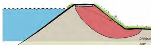
Figuur B3.2 Faalmechanisme Macrostabiliteit binnenwaarts
