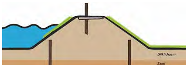
Figuur B2.8 Schematische weergave oplossingsrichting Constructies
