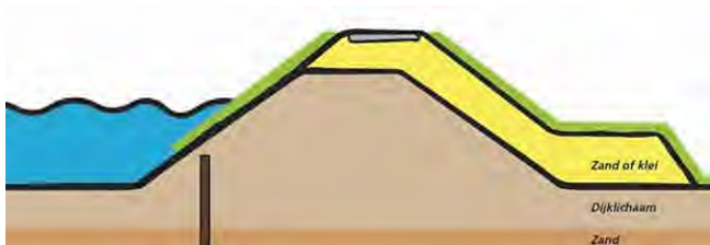
Figuur B3.5 Schematische weergave oplossingsrichting Grond binnenwaarts + constructies buitenzijde
