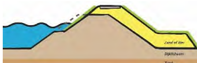
Figuur B3.4 Schematische weergave oplossingsrichting Grond binnenwaarts
