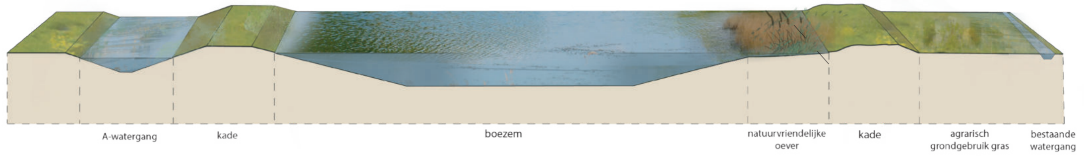
Principe doorsnede bij trace A/B ten noorden van het spoor incl. optie compensatie volkstuinen
